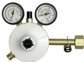
Le MMR est un détendeur de bouteilles à double étage qui fournit une pression de sortie stable. Le détendeur est conçu avec une compensation automatique de la chute de pression progressive dans une bouteille de gaz lorsque le gaz est utilisé.
